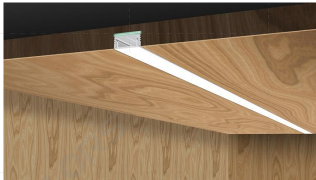
应用案例: 家具层板 开孔: 宽 17*深 8mm 玻璃胶固定
